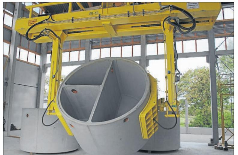
Neue Produktionstechnik: Aus Stahlformen werden nach dem Gießen fugenlose Betonbehälter, beispielsweise für Kleinkläranlagen, entnommen.
