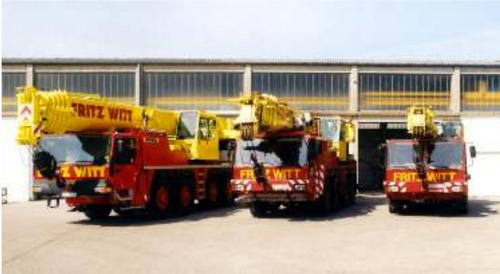
Autokrane mit Traglasten bis zu 80 t machten den Einbau sehr großer Betonfertigteile möglich.
