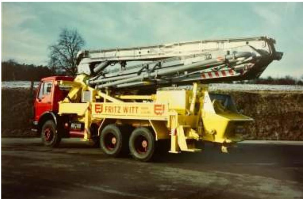
Putzmeister Betonpumpe mit einem 32 Meter Verteilermast
